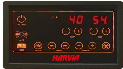
Käynnistä ohjain painamalla **päälle/pois**-symbolia. Lämmitysvastukset aloittavat lämmityksen. Saunan lämpötila ja lämmityksen toiminta-aika ovat näytössä. Lämmityksen toiminta-aika on automaattisesti 60 minuuttia tai viimeksi valitun toiminta-ajan mukainen. Mikäli painat uudelleen **päälle/pois**-symbolia, kaikki toiminnot (lämmityselementit, valaistus ja musiikki) kytkeytyvät pois päältä.
